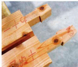
■大カマ仕口 材断面135mm以上は継ぎ手も大きく ※その他に長火打梁3尺間用～6尺間用も加工可能
